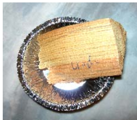
Figur 7.9 Ett urval av provbitarna till fuktkvotsmätningen. Bilderna visar några ytprover samt provernas storleksytterligheter.
